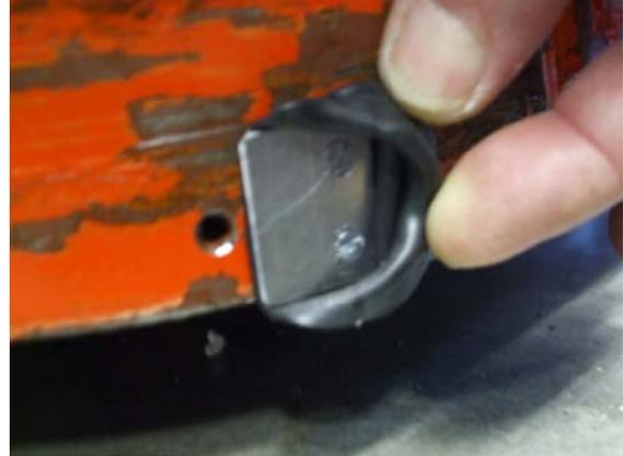
8. Bringen Sie die Endkappen an der Installationsfläche an und Schrauben diese mit M3 Senkkopfschrauben fest.
