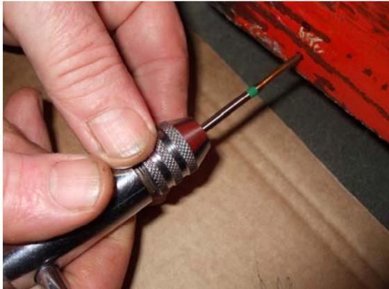
6. Schneiden Sie Gewinde in die Bohrungen für die Befestigung der Bleche.
