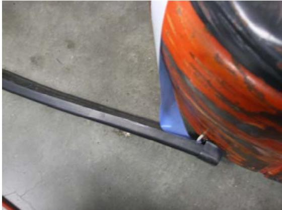
11. Entfernen Sie die Schutzschicht des doppelseitigen Klebebandes von der Rückseite der Schaltleiste.
